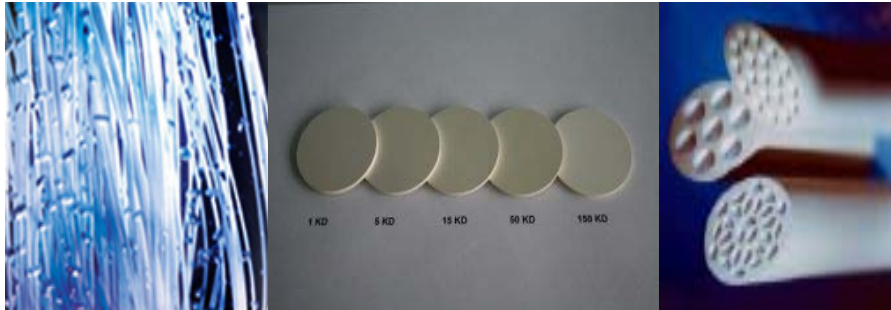
Figure 2 : Photos de membranes fibres, planes et multi tubulaires
