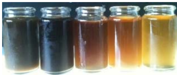
Figure I.3 : Abattement de couleur en fonction du seuil de coupure des membranes (digestat BIOD T1 brut, ultrafiltré à 300 kDa, ultrafiltré à 50 kDa (TERR T2 ici), ultrafiltré à 8 kDa et 1 kDa, respectivement de gauche à droite).
