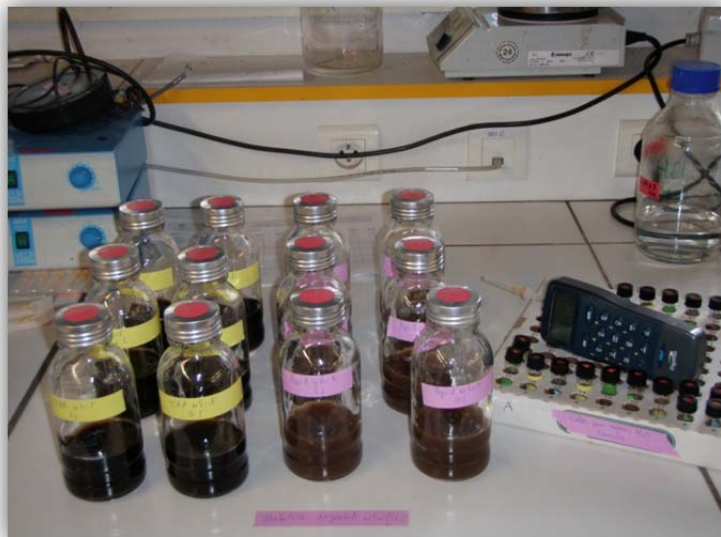
Figure 6. Dispositif du test de stabilité des digestats nitrifiés
