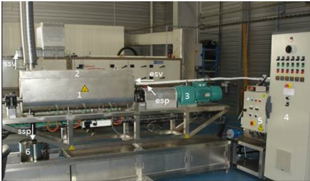
Vue d'ensemble du pilote de séchage
